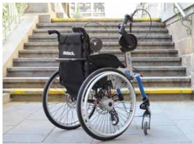
**K.U.R.T., der innovative, gelenkschonende Rollstuhlantrieb, in Betrieb**
